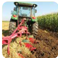
شخم زدن با گاوآهن یا با کلوش شکن دوردیفه پخش بقایای گیاهی تیمار شده
